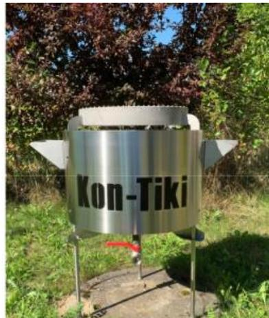
Nach diesem Prinzip arbeitet ein Kon – Tiki. Beim Kon – Tiki ist der Wirkungsgrad der Verkohlung höher als im Erdmeiler. Durch die Formgebung des Kon – Tikis sind die Strömungsverhältnisse nochmals optimiert worden. Die vorgewärmte Verbrennungsluft kann die
