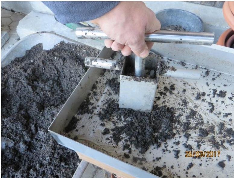
Der würfelförmige Teil des Presswerkzeuges wird auf eine glatte, ebene Fläche gestellt und mit der leicht feuchten Kompost-Erde-Mischung befüllt.
